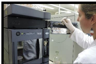
H: Análise Cromatográfica LC-MS/MS
